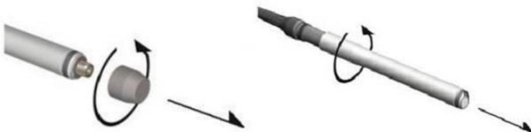
Чтобы снять цилиндр, отвинтите защитный колпачок или снимите насадку. Затем отвинтите его от корпуса наконечника лазера. Цилиндр можно стерилизовать, эта процедура описана в следующем абзаце.
