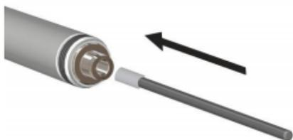
Поверните кисточку по часовой стрелке, чтобы полностью очистить линзу. Всегда устанавливайте на место защитный колпачок после снятия насадки или других аксессуаров.
