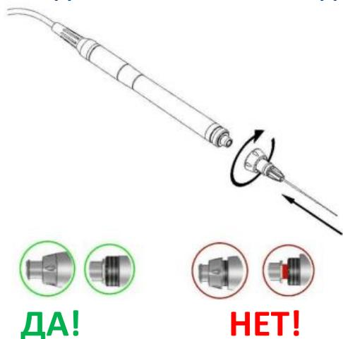
1. Снимите защитный колпачок с наконечника. Извлеките насадку и пластиковое кольцо из упаковки. Вставьте насадку в наконечник.
