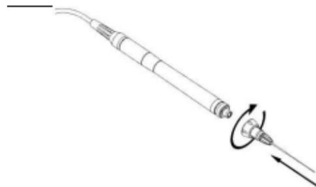
7. Снимите защитный колпачок, а затем наденьте насадку и наверните переходное кольцо.
