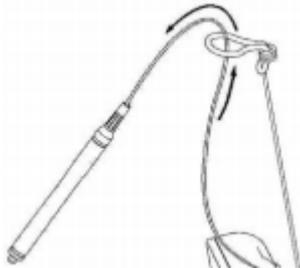
6. Пропустите оптический световод через кольцо держателя оптического световода.
